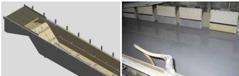
Oben: KTL-Wanne mit SIMONA® PP AlphaPlus® Inliner; unten links: technische Zeichnung der KTL-Wanne; unten rechts: mit Flüssiglack befüllte KTL-Wanne
